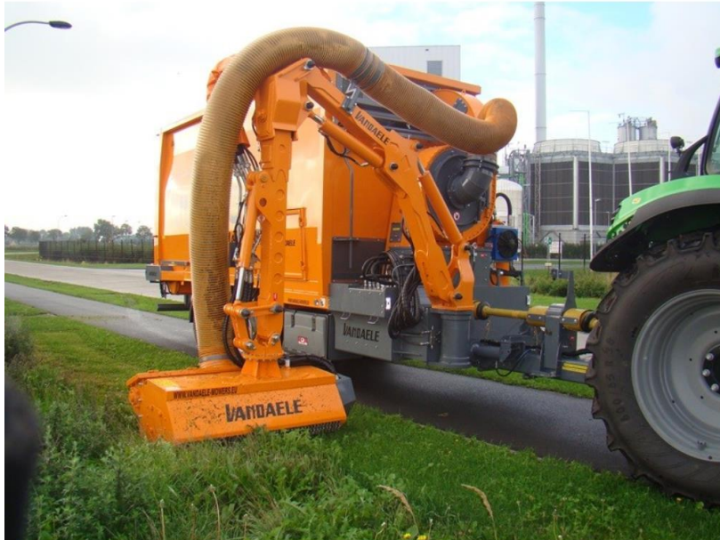
Figure 9 : Faucheuse avec aspiration des débris de fauche (Vandaele, 2019)
